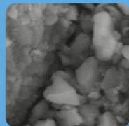
SEM-pilt (1 \mu\text{m} ; 20,000 x suurendus) Ceram X, Dentsply
